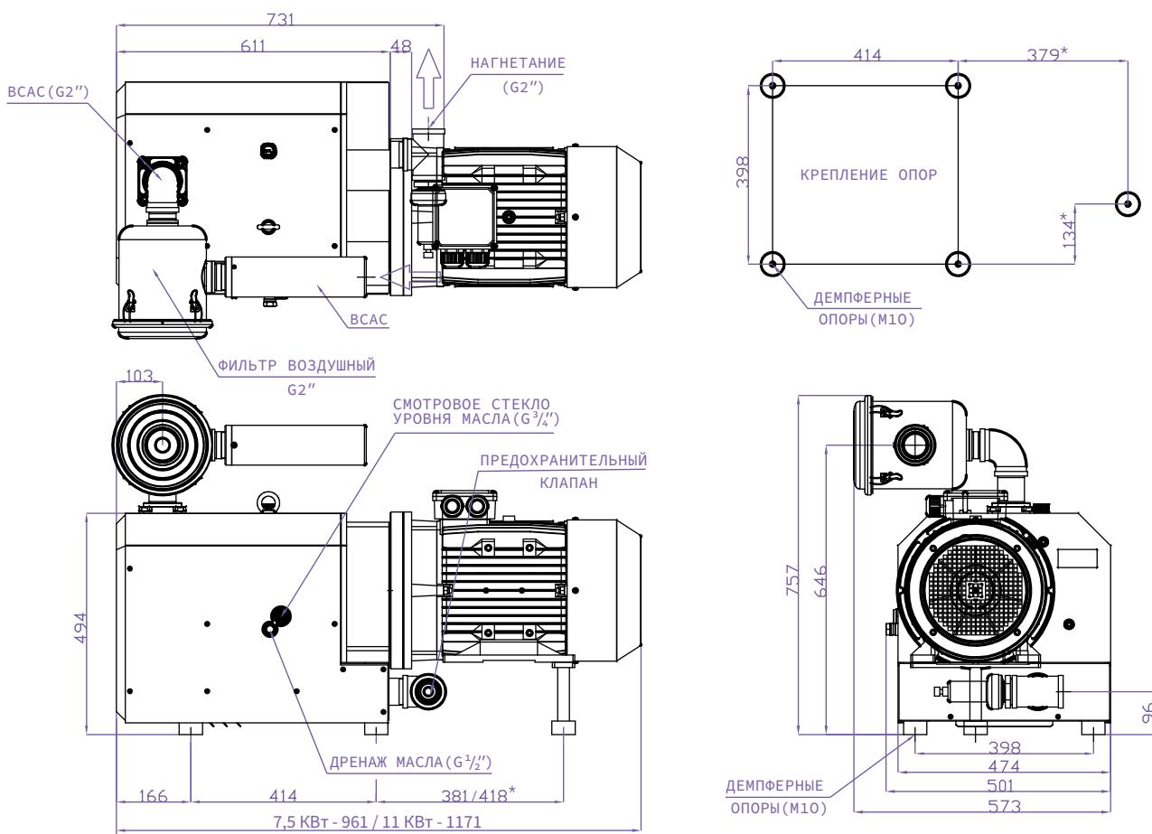
Все размеры на чертежах указаны в мм. \* Дополнительная опора электродвигателя 11 КВт.
