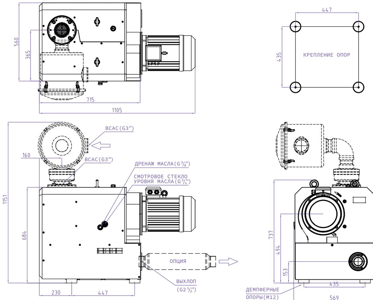
Все размеры на чертежах указаны в мм.
