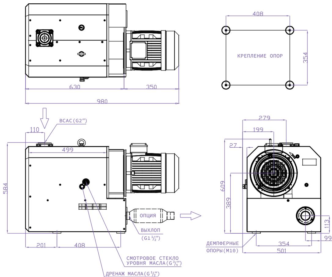
Все размеры на чертежах указаны в мм.
