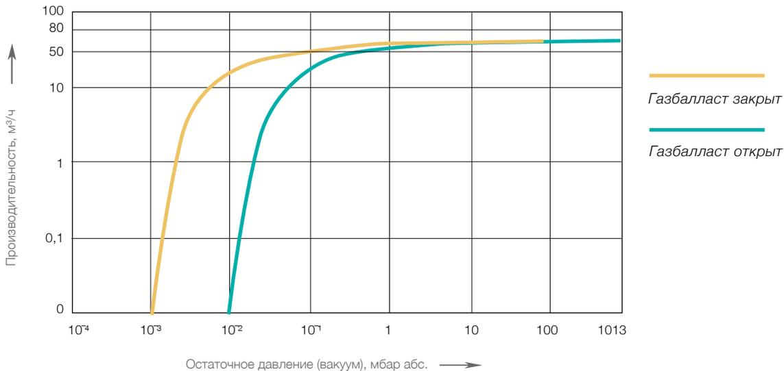
Представленные характеристики действительны для сухого воздуха при температуре 20°C и атмосферного давления на выхлопе насоса (1013 мбар). Погрешность характеристик ±10%.
